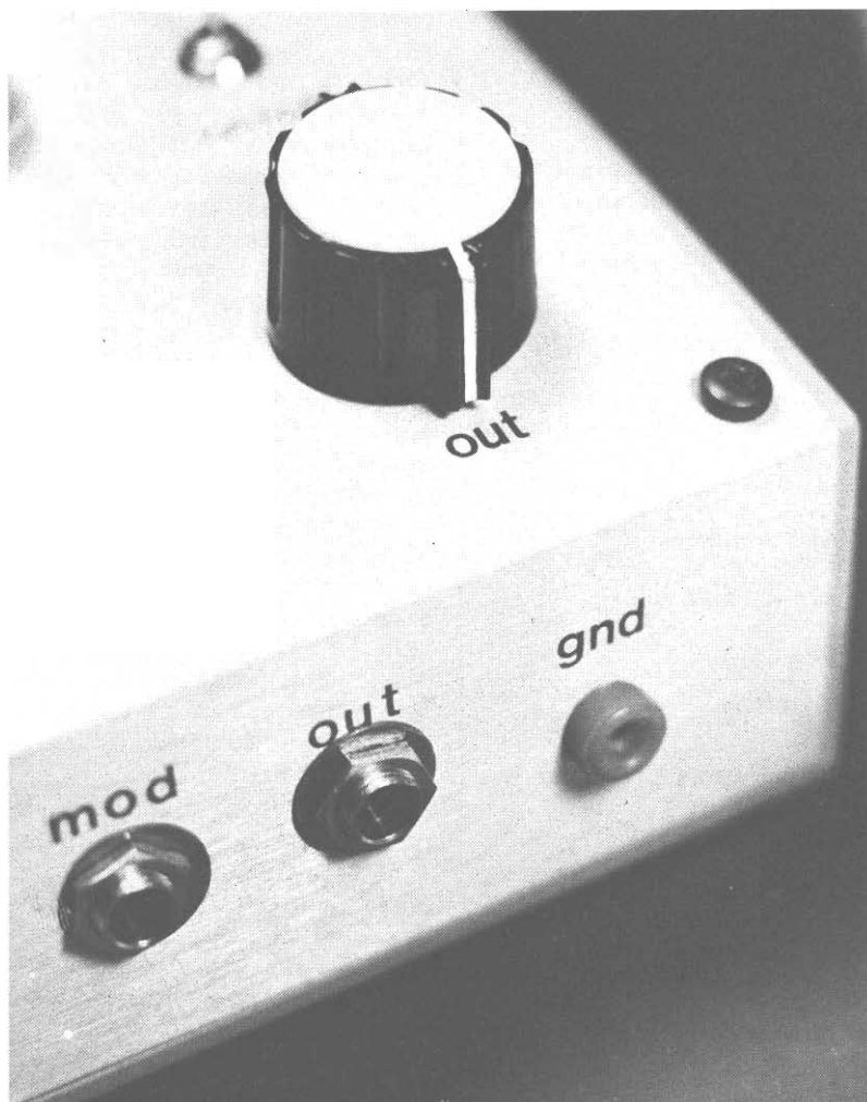
Nell'immagine un dettaglio del prototipo in cui appare il controllo generale di volume dell'amplificatore interno. Sul frontale dell'apparecchio si notano le connessioni per la massa, di uscita e per una modulazione esterna. All'uscita può essere collegato qualsiasi tipo di amplificatore di bassa frequenza; all'ingresso per modulazione esterna suggeriamo di collegare il generatore di effetti Star sound che vi abbiamo presentato nel giugno dello scorso anno.
